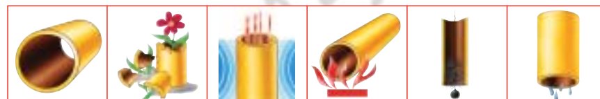
Rys. 4 W czasie montażu komina zabezpieczyć górną część przed deszczem. Zamknięcie izolacji mineralnej spowoduje nieprawidłowe działanie komina.
