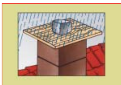
Rys. 4 W czasie montażu komina zabezpieczyć górną część przed deszczem. Zamknięcie izolacji mineralnej spowoduje nieprawidłowe działanie komina.
