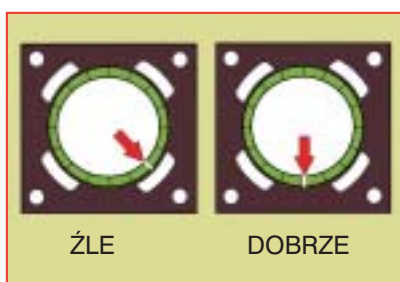
Rys. 1 Po odpowiednim docięciu izolacji umieścić ją w pustaku, tak by końce stykały się pośrodku pustaka.
